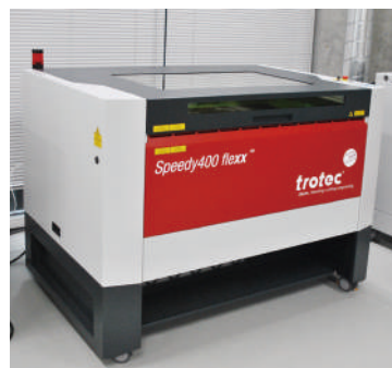
レーザー加工機 アクリルやプラスチック、木材などへの彫刻・カット・マーキングが可能。金属には彫刻、マーキングができる。
