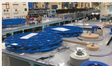
ワイヤーボンディング用電気ニッケルめっきを行う「リール to リール」方式のフープライン。画像解析技術を駆使したIoT化も進んでいる。
