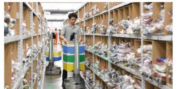
棚の前で待つAMRに、作業者が商品をピッキングして積み込む。作業者は棚のレイアウトを熟知することなくピッキング作業が可能であり、教育コスト削減も見込める。
