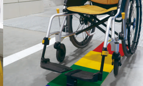
写真2 車いす楽器 色を音に変換するモジュールを搭載した車いす。色や音を楽しみながら操作方法を習得できます。
