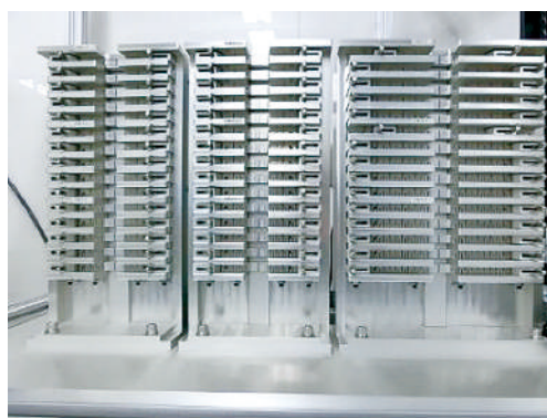
試験片のストック機能(最大で45本)
