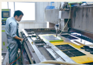
ウォータージェット4号機。重量物の加工に最適。
