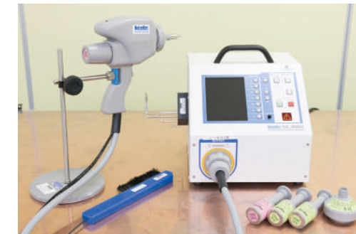
写真4 静電気放電試験
