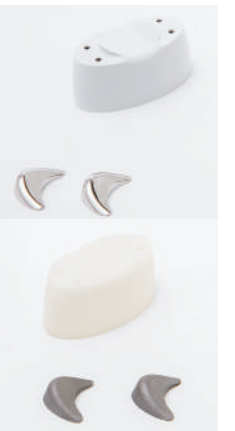
都産技研の3Dプリンターを使用して、電極部(手前)やボディ(奥)を試作。
