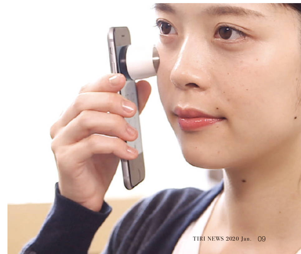
スマートフォン画面に表示される光の点滅を製品本体に組み込まれた照度センサーが読み取り、電極から皮膚に通電して筋肉を刺激する。
