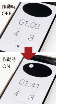
スマートフォン画面に表示される光の点滅を製品本体に組み込まれた照度センサーが読み取り、電極から皮膚に通電して筋肉を刺激する。
