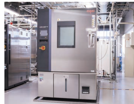
急速温度変化が可能な「ハイパワー恒温恒湿槽」。温度範囲-70～+180℃、温度変化速度15℃/分(無試料)に対応。
