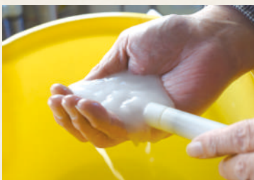
ノズル（右下）から、マイクロバブルを含ませた水道水を射出した様子。細かな泡を高濃度で発生させるため、乳白色に見える。
