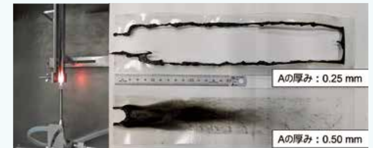
図2 垂直燃焼試験の一例とその結果
