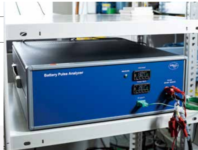
秒速バッテリー診断デバイス。電池の劣化状態などを高速かつ高精度で診断可能。
