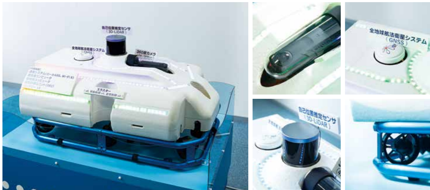
LiDAR（レーザー照射による距離検出）やGNSS（汎地球測位航法衛星システム）によってロボットの正確な位置を把握し、下部に設置した8つのスクリューを制御して、波で揺れる機体を安定させて航行。栈橋を撮影した画像をリアルタイムで送信する。
