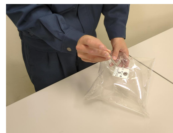
臭気用サンプリングバッグに人工尿臭試薬を添加した様子
