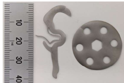
本手法で作製した薄型・小型製品 ※材料: 析出硬化系ステンレス (SUS630相当)
