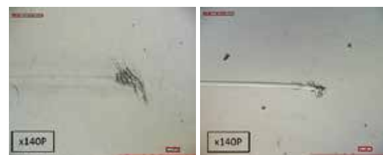
図2 PETフィルム (100μm厚) 上のきず (左: 6H鉛筆、右: ダイヤモンド先端引っかかり針 (80g荷重))
