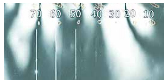
図3 MHJ-280で観察された機能性フィルム上のきず
