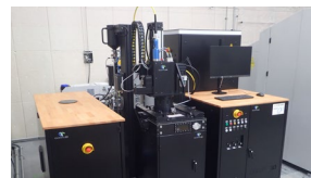
金属3Dプリンター （さまざまな材料の造形に対応可能）
